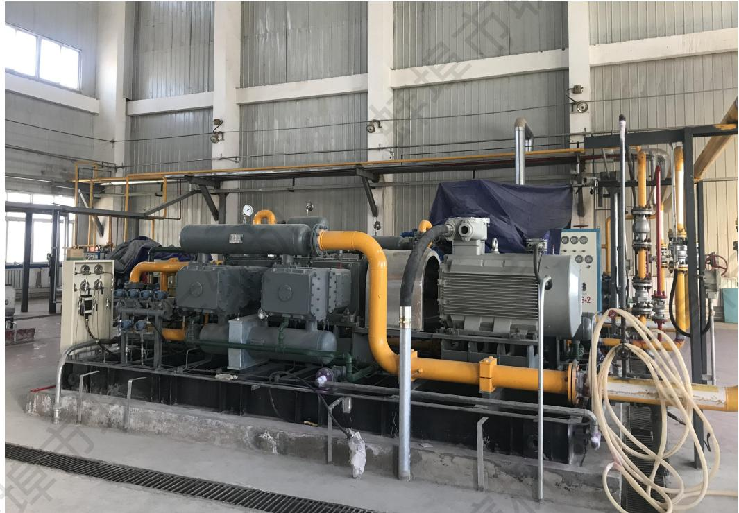
MW-15.2/ (0.05-0.15) -40采用动力平衡性能优秀的四列对称平衡M型机型，四列、三级压缩。机身的两侧各布置两列，机身的两侧各布置两列，一级气缸占两列位于机身一侧，二、三级气缸各占一列位于机身另一侧，所有气缸均为双作用气缸。气缸、填料皆为无油结构，无油润滑。压缩机气缸、填料采用水冷式，冷却器采用列管式，换热管材质采用304不锈钢。机组应在压缩机数据表所规定的全部工况下能有效地安全可靠地连续运行操作，机组橇装。
