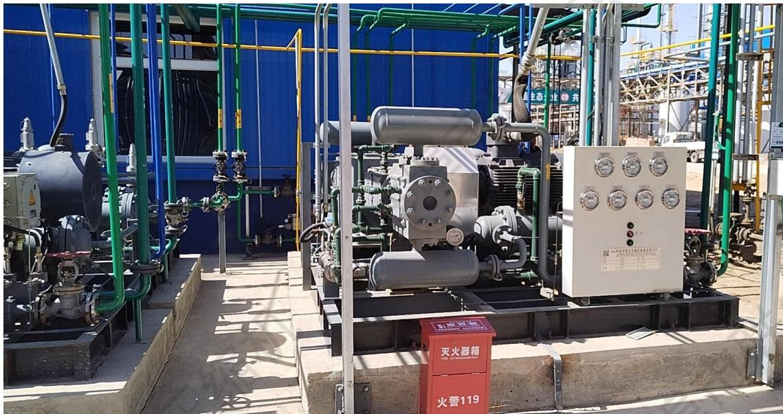
DW-0.96/(4-5)-60型氢气压缩机为两列三级压缩，一级双作用，二三级差，介质水冷，气缸水冷无油润滑，有基础活塞式压缩机。气缸的排列为D型对称平衡式.该压缩机组具有耗能少、噪音低、振动小、可靠性高、无油润滑、操作简便等特点。
